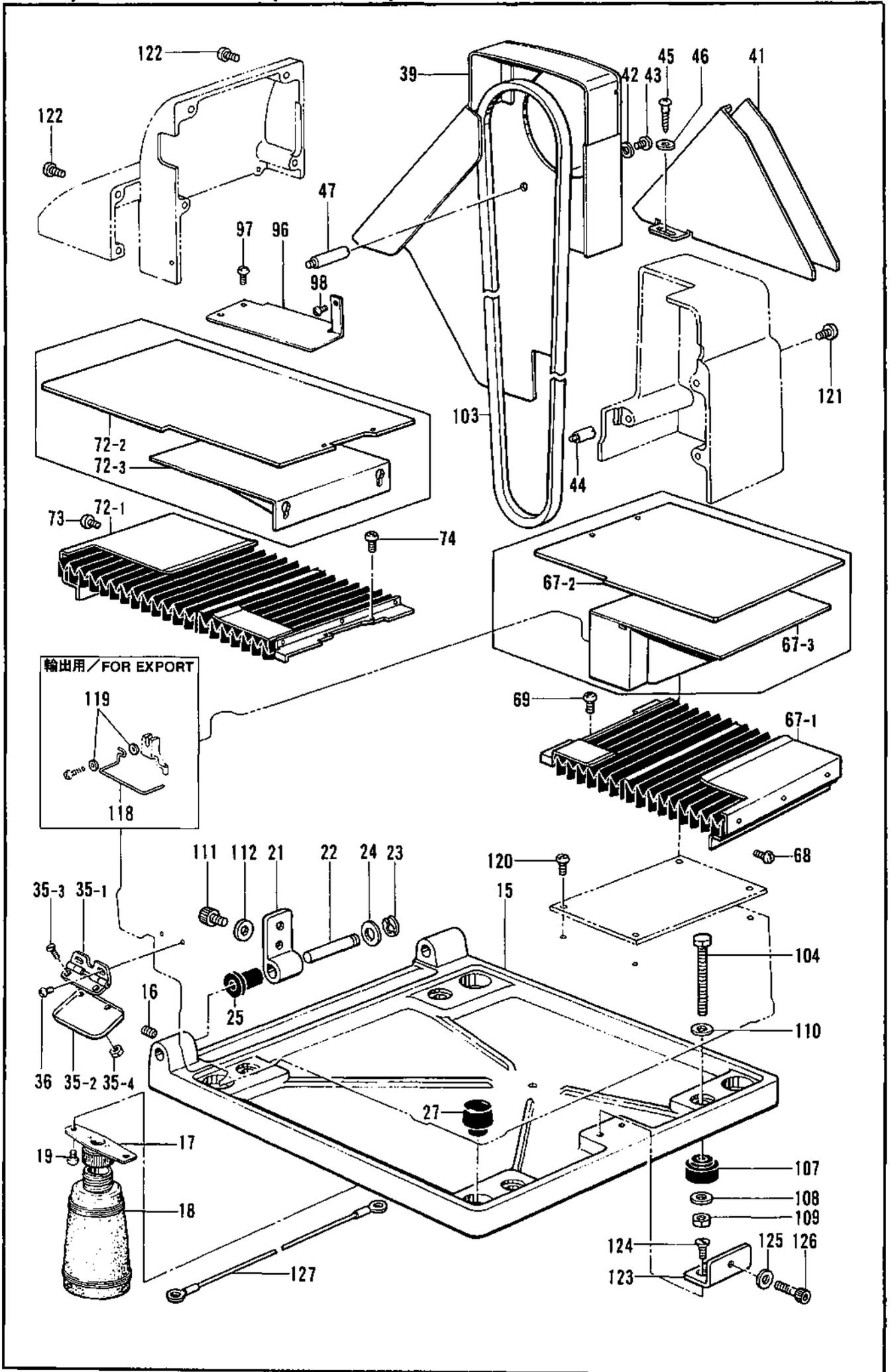
A2. 主体関係/Machine body/Maschinengehäuse/
