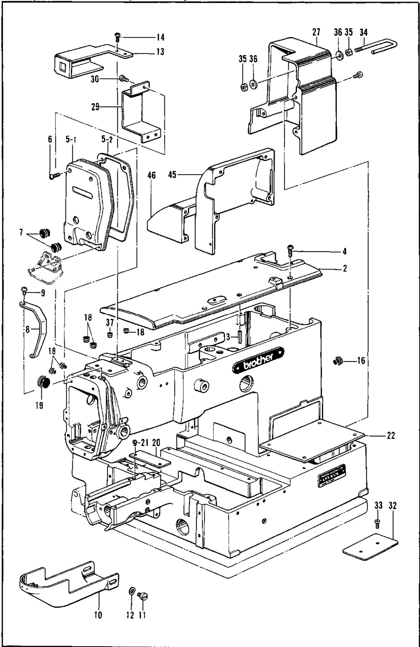
A1. 主体関係 / Machine body / Maschinengehäuse /
