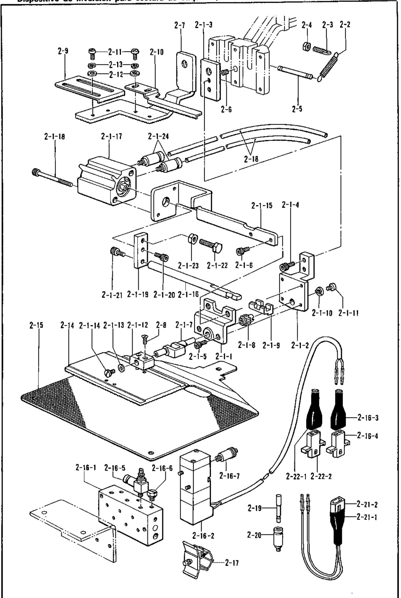
V2. ネーム付反転装置 エアー仕様 (オプション)/Reversing device for label sewing, pneumatic drive (option)/
