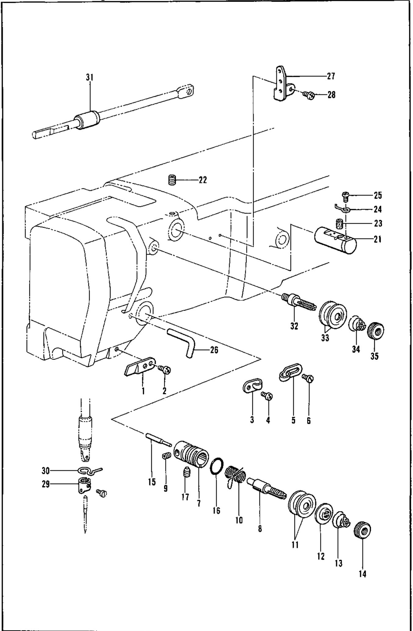
H. 糸通シ関係 / Threading mechanism / FadenführungsVorrichtung /
