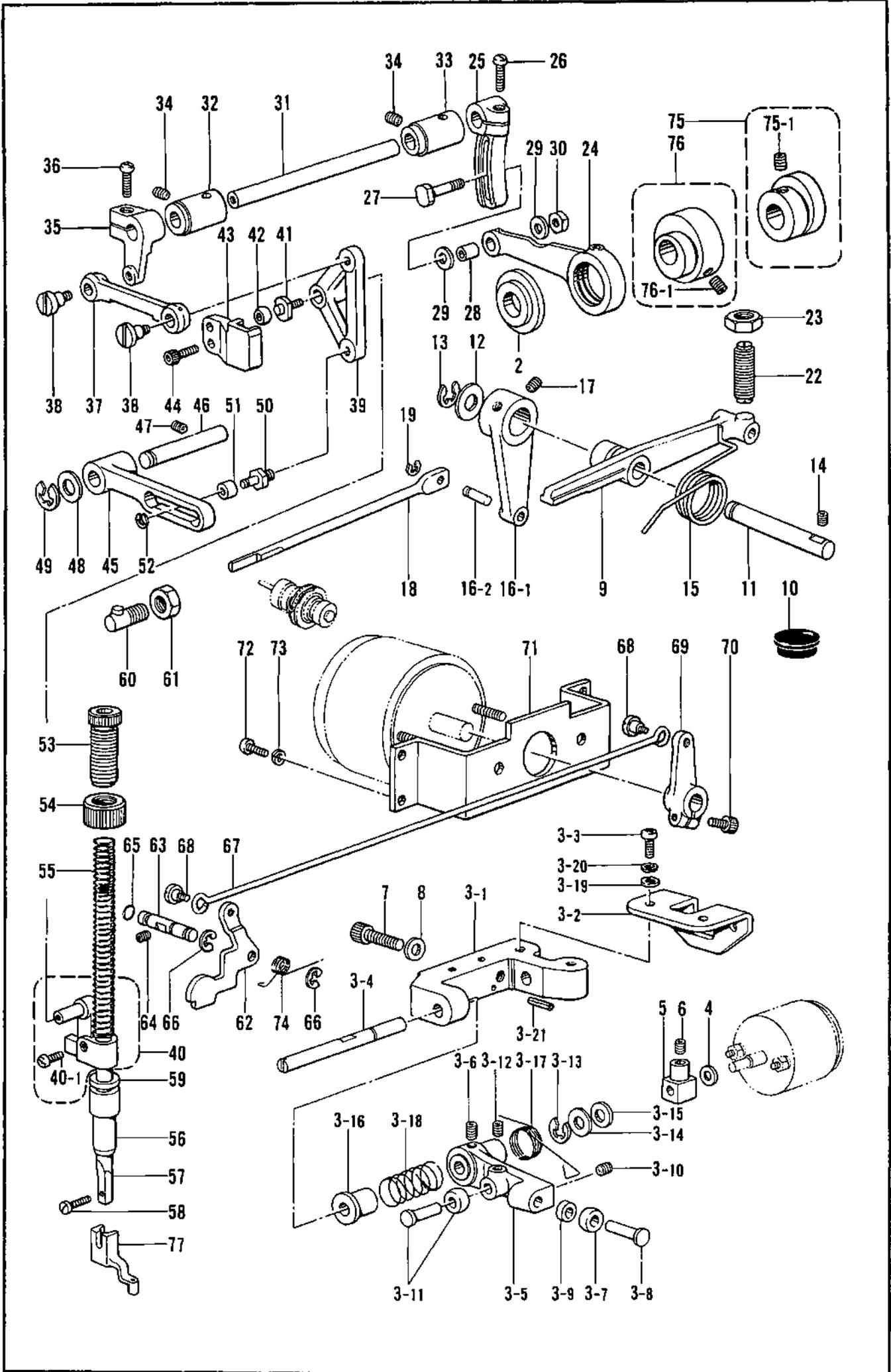
D. 押工上ケ関係/Work Clamp Lifter mechanism/Stoffhalterhebevorrchtung/
